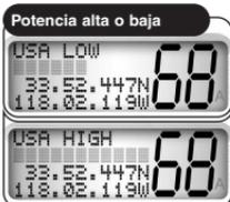
En una situación de emergencia, cuando utiliza el mapa de canales para EE.UU., usted puede presionar sostenidamente el botón de **alta y baja potencia** para anular la modalidad de **baja potencia** si necesita aumentar la potencia de salida en los canales 13 y 67 para que su señal pueda ser escuchada.
