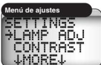
En el menú de **ajustes**, puede desplazarse a través del menú para hacer todos los cambios que desee. Siempre que la flecha de selección de ajustes aparezca en una de las porciones de función del menú, ésta señalará el ajuste que estaba en efecto cuando usted accedió al menú.
