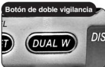
La pantalla indicará doble vigilancia y el radio rastreará entre el canal 16 y la segunda ubicación de doble vigilancia seleccionada por usted. Al detectarse una (1) señal en cualquiera de los dos (2) canales se detiene el rastreo para que usted oiga el tráfico en ese canal. La pantalla mostrará el número de canal.
